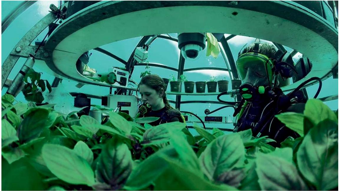
••• divers types de plastique et de plexiglas, souples et rigides, qui assurent la transparence, et sont situées à une profondeur de 7 mètres. Respectant un principe de physique, tout comme un verre placé à l'envers dans un bassin d'eau, elles sont remplies d'air et l'eau ne peut y pénétrer. «Jusqu'à présent, pour toutes les difficultés rencontrées, nous avons trouvé des solu-
